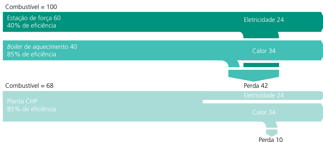
Figura 10 | Comparação do rendimento energético: convencional e cogeração
