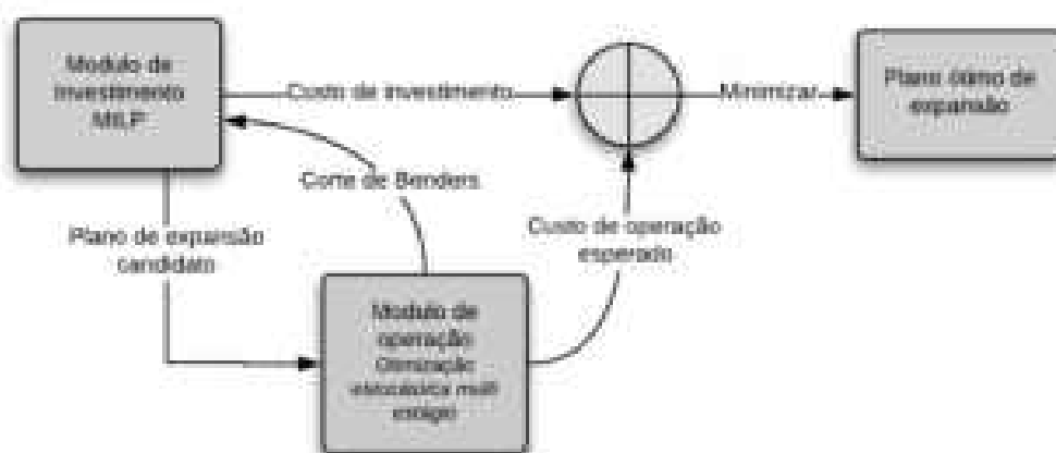
Figura 2.1 – Otimização do problema de planejamento da expansão por decomposição de Benders
