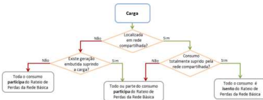
Figura 8: Fluxo de identificação de quantidades isentas do Rateio de Perdas da Rede Básica para pontos de consumo
