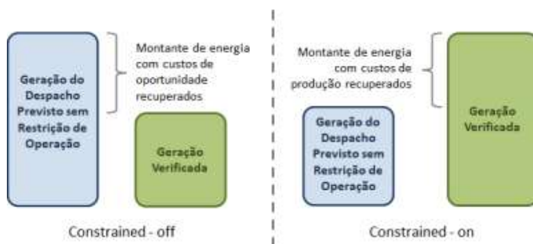
Figura 2: Tipos de Restrição de Operação: Constrained-Off e Constrained-On
