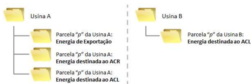
Figura 3: Esquema de modelagem de parcelas “p” de uma usina A ou B
